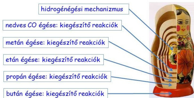
2.21. ábra A magas hőmérsékletű alkánoxidáció reakciómechanizmusai egymásba ágyazódnak
